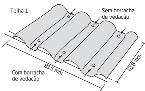
Para as demais telhas, fixar com três parafusos sem a borracha de vedação. O parafuso ficará coberto pela próxima telha e protegido contra infiltrações.
