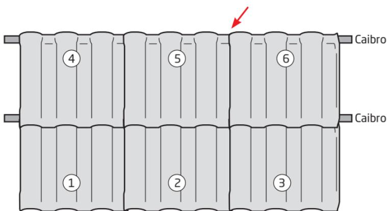
Para instalação da primeira fiada de telha é necessária a utilização de uma ripa adicional de 2 cm de espessura, para conferir inclinação e alinhamento corretos ao telhado.
